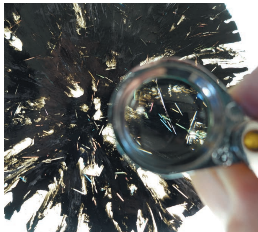
▲一般的な破砕機でリサイクルされた光ファイバープラスチックでは、コアのワイヤーが混合されていない。
