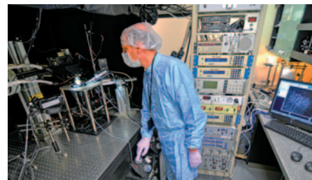
OISTの光学ニューロイメージングユニットで in vitro および in vivo での観察のために組み立てられた二光子顕微鏡
