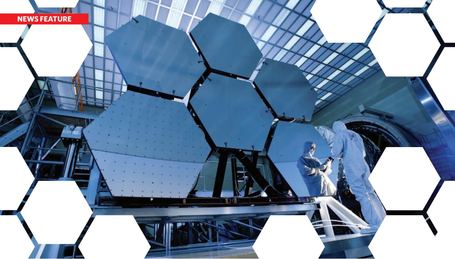
極低温試験を実施するため、ジェームズ・ウェッブ宇宙望遠鏡の主鏡を構成する 18 枚のセグメントのうち 6 枚を準備する NASA の技術者。
