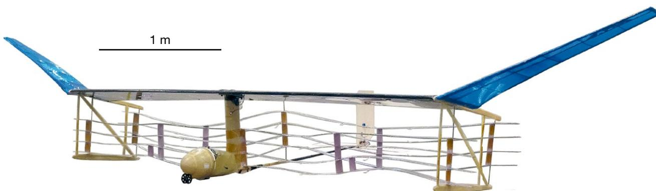
Xuらが製作したイオン風推進飛行機
