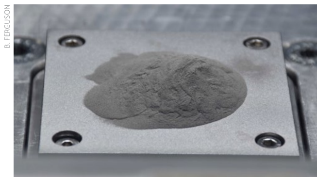
3Dプリンターにセットされた、ナノ粒子で修飾された金属粉末。
