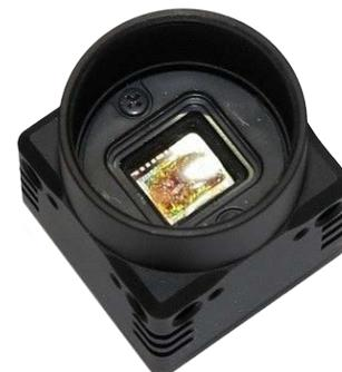
195個のCQDフィルターをデジタルカメラのCCDアレイセンサーと組み合わせたCQD分光計。大きさは10円硬貨よりやや大きい程度。
