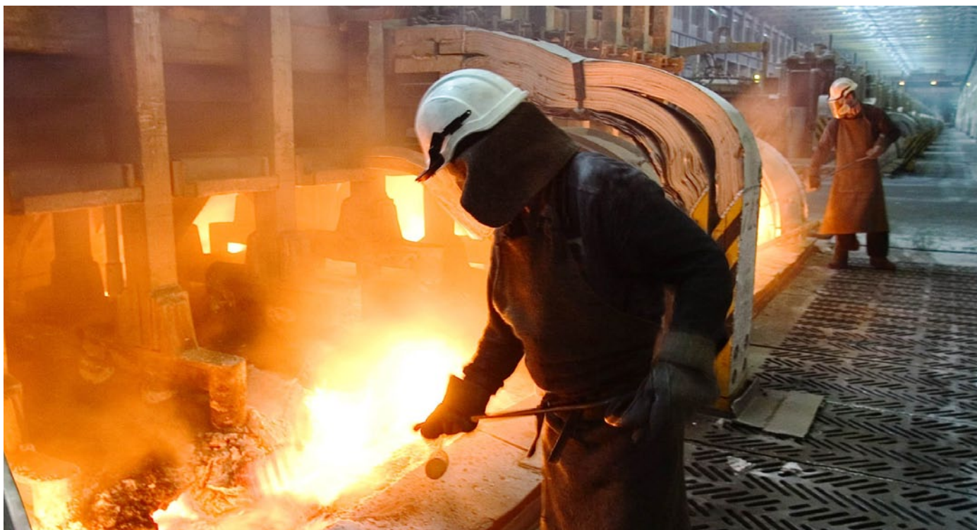
図1 電気分解（電解）による金属の抽出
