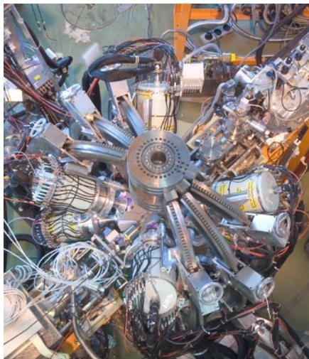
物理学者のチームは、ガンマ線分光装置（写真）を用いて、ラジウム 224 の原子核が洋ナシのように一端が盛り上がった形をしていることを明らかにした。
