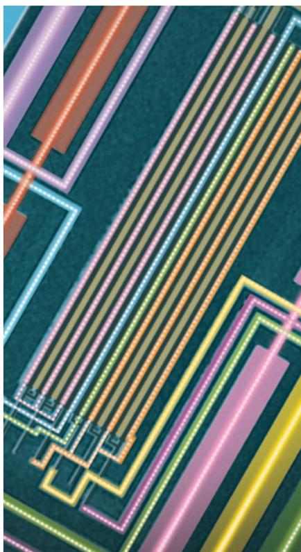
して、複数本の半導体ナノチューブを平行に配置したトランジスターを作製し、各トランジスターが完璧に動作することを確認した。
