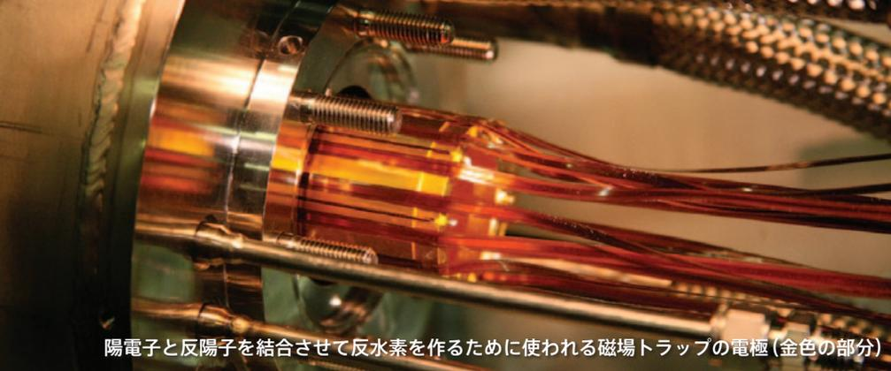
陽電子と反陽子を結合させて反水素を作るために使われる磁場トラップの電極(金色の部分)
