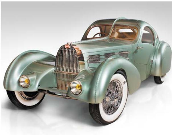
図1 1930年代にフランス・ブガッティ社が発表した軽量自動車「エアロライト」。車体にマグネシウム合金を使用している。
