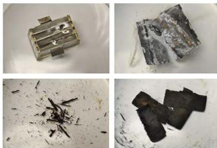
生分解性材料でできた4セル電池は、3週間後、完全に水に溶ける。
